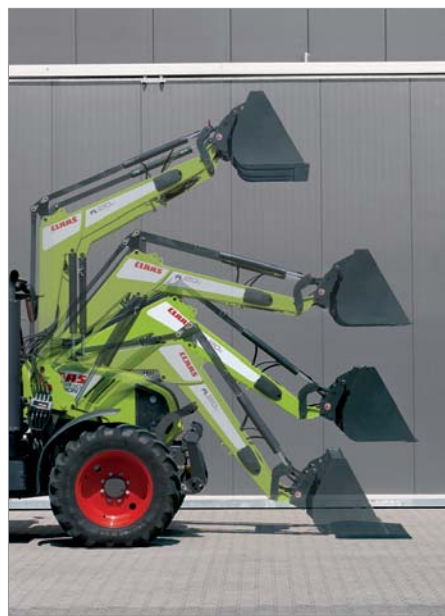
Погрузчики модельного ряда FL оснащены гидравлическим параллелограммным механизмом, который автоматически корректирует угол наклона рабочего устройства
