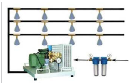
Рис. 1. Принцип действия системы распыления воды под высоким давлением
