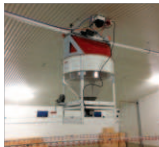
Современный разбрасыватель с автоматическим режимом наполнения и прямым приводным двигателем для оптимального распределения корма (фото предоставлено компанией Collinson PLC)
