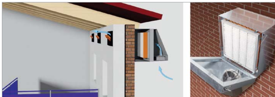
Рис. 2. Схема работы ART 1500 для подачи отфильтрованного воздуха через стеновой клапан CL 1200
