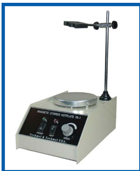
Рис. 4. «Нижняя» магнитная мешалка с подогревом
