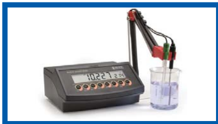
Рис. 1. pH-метр с дискретностью до третьего знака после запятой
