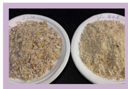
На образце справа видно: Murska W-Max 20 C плюстит еще лучше, чем Murska 2000 S 2x2
