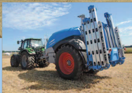
При помощи гидравлики Vega 12 раскладывается в ширину
