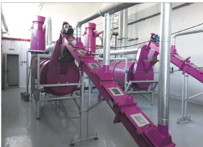
Линия экструдирования сои на комбикормовом заводе
