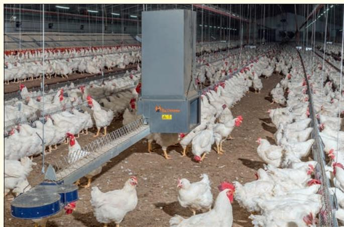
*Рис. 4. Кормовая система с цепной кормораздачей MaleChain для петухов*
