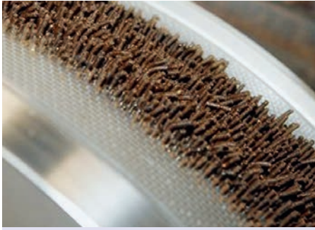
Фото 1. Матрица пресс-гранулятора на заводе «Де Хёс» для получения гранул диаметром от 2 до 4 мм
